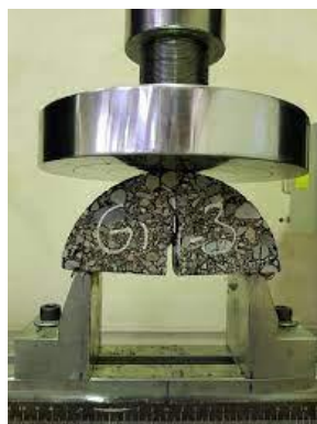
شکل ۸: قاب بارگذاری آزمایش شکست و نمونه آزمایش
