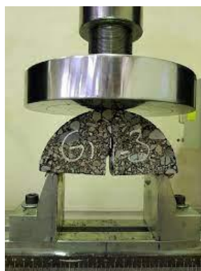
شکل ۸: قاب بارگذاری آزمایش شکست و نمونه آزمایش
